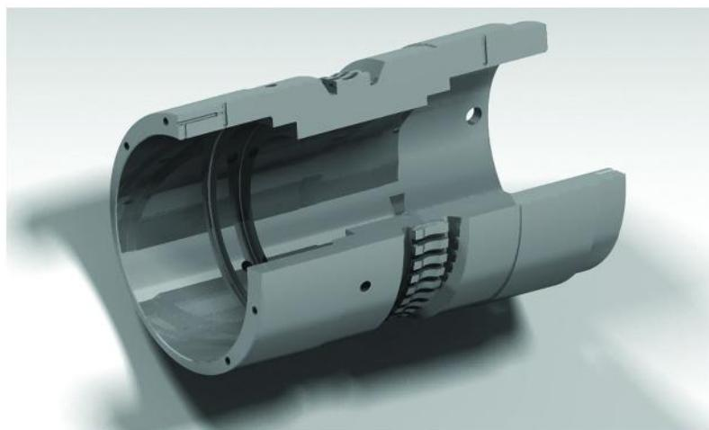
بوش استند با دندانه های خارج از مرکز به قطر ۴۳۰ میلیمتر و طول ۷۱۰ میلیمتر از جنس فولاد 42CrMo4
